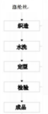
图 2.6-5 广告布、油画布、服装面料坯布生产线工艺流程图
